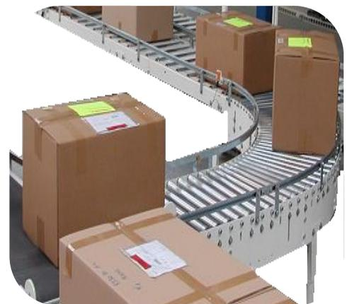
*Le CCR175 est une courbe dont les rouleaux sont entraînés par une courroie ronde en contrainte sous le rouleau. Elle s'intègre parfaitement dans votre circuit pour faciliter le transport continu.*
