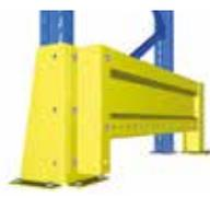
Un trafic intense sur les extrémités des rayonnages, voire dans les passages pont, occasionne souvent des dommages à l'installation. La protection d'extrémité Stow est composée d'une lisse principale en profil sigma, boulonnée sur deux pieds. Des pieds intermédiaires sont rajoutés pour des longueurs plus importantes.
